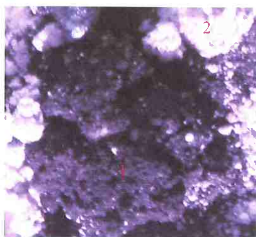
Figura 21 - Aspectos visuais de uma pelota tipo 2 aquecida à 700°C por 5 minutos e reduzida à 1400°C por 5 minutos. 1 – Pelota e 2 – alumina.
